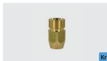
M22 GZ : GW. 6-kątny. Max. 400 bar / 150 °C
