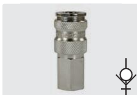
Złącze : GW. Niklowany mosiądz. Z zaworem. Max. 35 bar / 100 °C
