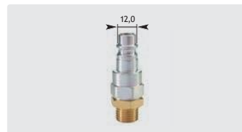
Wtyk : M. \varnothing 12 mm. Stal hartowana, niklowana chemicznie/cynkowana i mosiądz. Max. 200 bar / 100 °C
