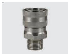
Złącze : GZ. Stal nierdzewna. 60° stożek. Max. 250 bar / 150 °C
