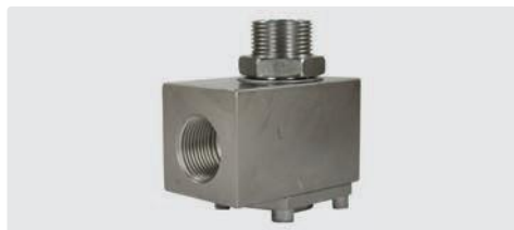
3/4" GW : 3/4" GZ. DN 19. Obudowa i oś ze stali nierdzewnej. Max. 200 bar / 90 °C
