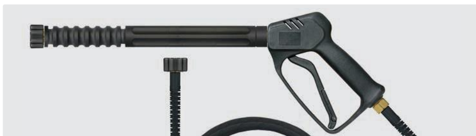
Pistolet z przedłużeniem 340 mm, max. 210 bar / 25 l/min / 150 °C. WE / WE M22 GW. Wąż: 6 - 160 (wewnątrz poliester), max. 160 bar / 20 °C
