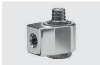
1/4" GW : 1/4" GZ. DN 7. Max. 275 bar / 30 r.p.m. / 120 °C
