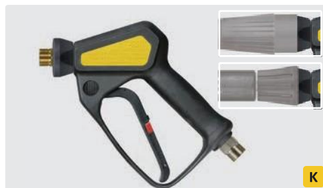
Pistolet z izolowanym wylotem przystosowanym do lanc z obrotem. zł. śrubowe. Max. 310 bar / 45 l/min / 150 °C
