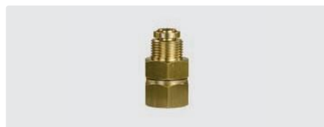
3/8" GZ : 1/4" GW. Mosiądz. Max. 220 bar / 90 °C
