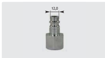
Wtyk : GW. \varnothing 12 mm. Stal hartowana, niklowane chemicznie / cynkowane. Max. 200 bar / 100 °C
