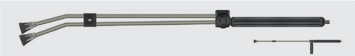
1/4" GZ. Lanca z uchwytem modułowym, zaworem bocznym ST-54 i osłoną dyszy ST-10 z dyszą niskociśnieniową i gniazdem 1/4" GW. Max. 310 bar / 150 °C
