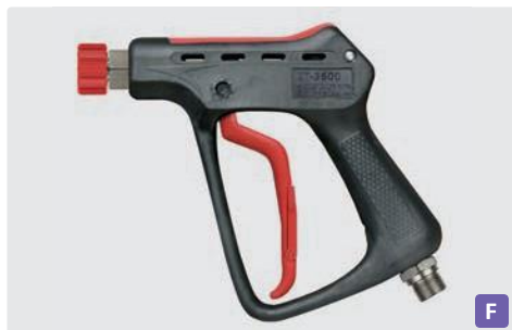
Pistolet ultrawysokociśnieniowy z M22 GZ. Max. 500 bar / 80 l/min / 150 °C
