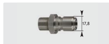
Wtyk : GZ. Stal nierdz.. 60° stożek. Max. 250 bar / 150 °C
