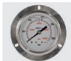
Ø 63 mm. 1/4" GZ. Z pierścieniem montaż. Obudowa stal nierdzewna. Wlot z tyłu
