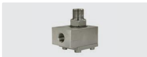
1/4" GW : 3/8" GZ. DN 6. Obudowa i oś ze stali nierdzewnej. Max. 600 bar / 90 °C
