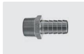
Kolec do węża 3/4" GZ. 60° stożek. Stal nierdz.. Max. 15 bar
