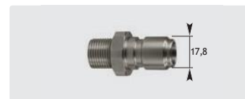
Wtyk : GZ. Stal nierdzewna. 60° stożek. Max. 250 bar / 150 °C
