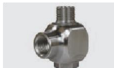
1/2"GW : 1/2"GZ. DN 12. Zest. napr. ST-322 Max. 300 bar / 30 r.p.m. / 90 ^{\circ}\text{C}
