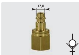
Wtyk : GW. \varnothing 12 mm. Mosiądz. Z zaworem. Max. 35 bar / 100 °C
