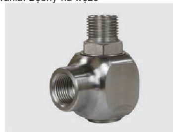
1/2" GW : 1/2" GZ. DN 12. Max. 300 bar / 30 r.p.m. / 90 °C
