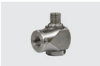
1/4" GW : 1/4" GZ. Max. 400 bar / 30 r.p.m. / 90 °C
