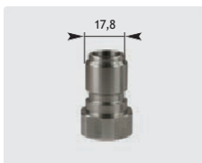
Wtyk : GW. Stal nierdzewna. Max. 250 bar / 150 °C
