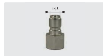
Wtyk : GW. \varnothing 14.8 mm. Stal ocynk.. Max. 250 bar / 100 °C
