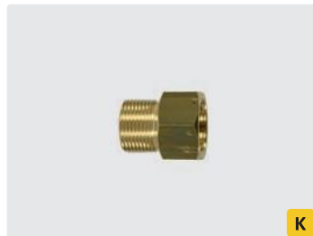
M22 GW : M22 GZ. K 2000. Mosiądz. Max. 400 bar
