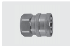
Złącze : GW. Stal nierdz. V2A. Max. 350 bar / 100 °C
