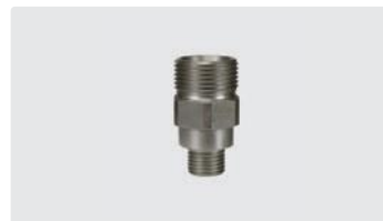
M22 GZ : 1/4" GZ. Długi. Max. 400 bar / 150 °C
