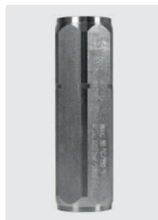
1/2" GW. Stal nierdzew. 90 mm. Ciśnienie otwarcia 0.05 - 0.1 bar. Max. 400 bar / 90 °C
