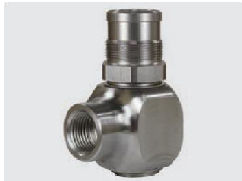
M28 GZ. DN 12. Do serii R+M 434 - R+M 564. Max. 300 bar / 30 r.p.m. / 90 °C
