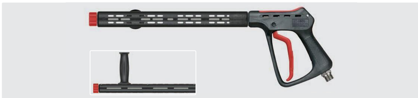
Pistolet ultrawysokociśnieniowy z przedłużeniem ST-9 380 mm, uchwytem i M22 GZ. Max. 500 bar / 80 l/min / 150 °C
