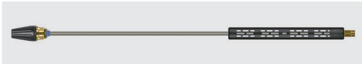
M22 GZ. Lanca z uchwytem wentylowanym ST-9 380 mm i dyszą wirową ST-458.1. Kąt natrysku 20°. 200 - 400 bar. Max. 100 °C
