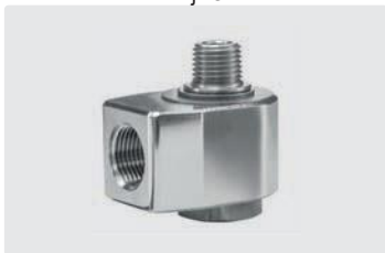
3/8" GW : 1/4" GZ. DN 7. Max. 275 bar / 30 r.p.m. / 120 °C
