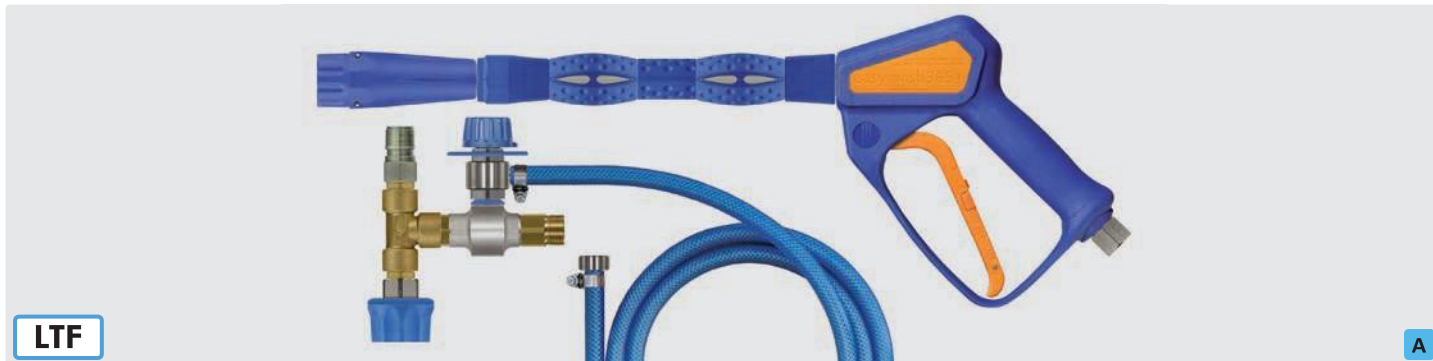
easywash365+ zestaw pianowy: lancia do piany easywash365+ standard z głowicą pianową ST-75, iniektor ST-160 (złącze ST-45-250 mosiądz niklowany, wtyk ST-45-250 stal ocynk. i M22 GZ) z zaworem dozującym ST-161, wąż ssący 1,000 mm i filtr ssący ST-32. Max. 310 bar / 90 °C
