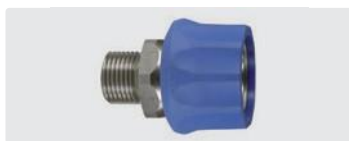
Złącze : GZ. Stal nierdzewna. 60° stożek. Max. 250 bar / 150 °C
