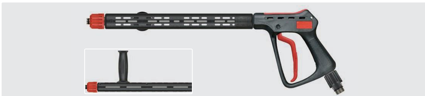
Pistolet ultrawysokociśnieniowy z rozszerzeniem ST-9 380 mm, uchwytem i szybkozłączem ST-740. Max. 600 bar / 80 l/min / 150 °C
