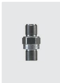
1/4" GZ. Stal nierdzew. 37.8 mm. Ciśnienie otwarcia 0.05 - 0.1 bar. Max. 400 bar / 90 °C
