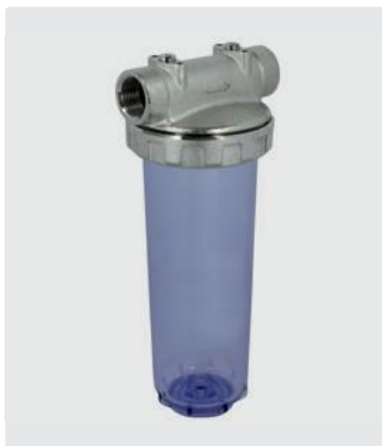
3-część. Z odpływem. Główna niklowany mosiądz. Pojemnik plastik. Max. 15 bar / 40 °C
