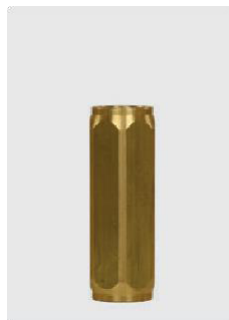
3/8" GW. Mosiądz. 65 mm. Ciśnienie otwarcia 0.05 - 0.1 bar. Max. 150 bar / 90 °C
