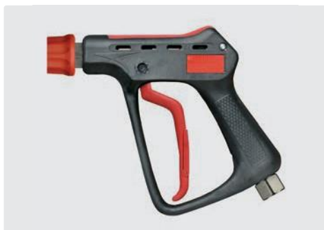
Pistolet ultrawysokociśnieniowy ze złączem ST-45. Max. 600 bar / 80 l/min / 150 °C
