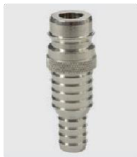
ST-45. Mosiądz niklowany. Szybkozłącze Wejście na wąż 13-19 mm. 25 bar / 90° C
