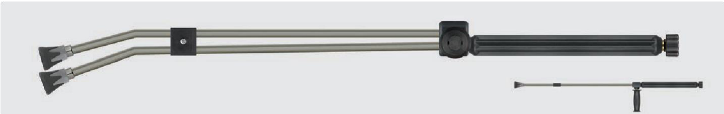
M22 GW. Lanca z uchwytem modułowym, zaworem bocznym ST-54 i osłoną dyszy ST-10 z dyszą niskociśnieniową i gniazdem 1/4" GW. Max. 310 bar / 150 °C
