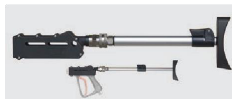
ST-3900 wsparcie ramienia. Nowe wytyczne UE bezwzględnie zalecają stos. podpórek barkowych do zastosowań związanych z czyszczeniem, których siła reakcji przekracza 150 N. ST-3900 z płynną regulacją. Złącze obrotowe. Pasuje do pistoletów ST-3600 / ST-3500.
