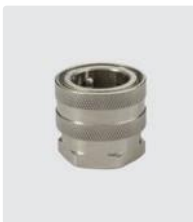
ST-45. Mosiądz niklowany. Gniazdo szybkozł. : 3/4" GW. 25 bar / 90° C
